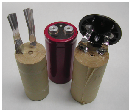
FIGURA 1. Capacitores eletrolíticos de alumínio. Os enrolamentos são compostos por folhas de alumínio e separadores de celulose, e exibem anisotropia térmica.
